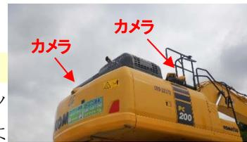
写真 13 重機にカメラ設置
