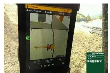
ICT建機内の施工状況を確認するモニター
