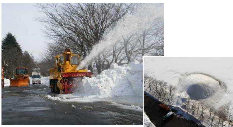
H24のロータリー除雪車及び外堀への投雪状況
