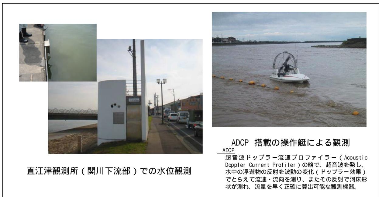
図 5-27 洪水ピーク時に推定される河床形状の調査
