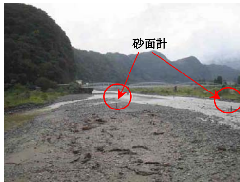
砂面計設置状況-1
