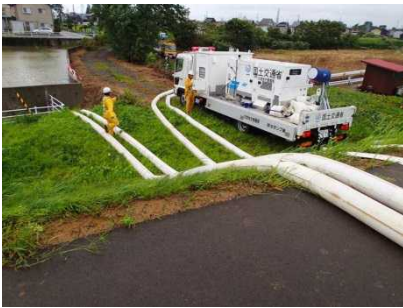
保倉川左岸0.2k 排水ポンプ車稼働状況
