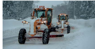
グレーダーによる除雪状況
