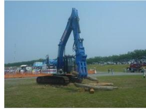
無人バックホウによる流木撤去作業
