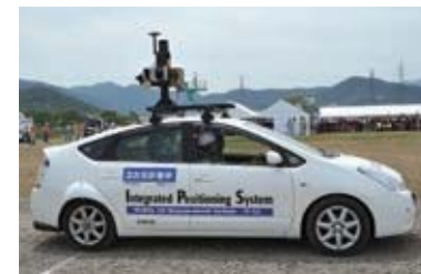
モバイルマッピングシステム及び UAV による災害現場調査、被災調査
