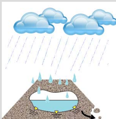
図6.2.2 雨水浸透による堤防の破壊
