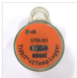
写真1 河川水温の計測機器
