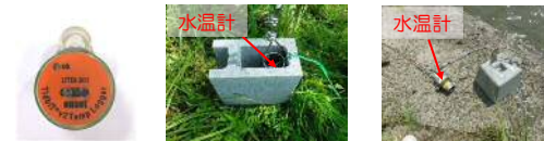
左: 自記式水温計 右: ブロックに固定し投入 百合居橋の水温計 西大滝ダム魚道の水温計
