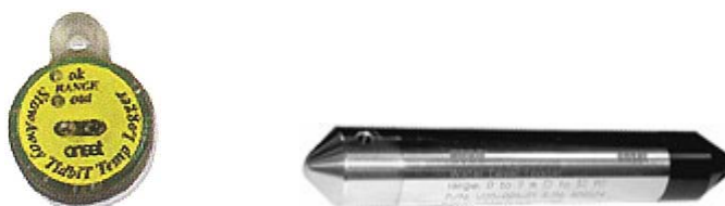
図 2.1-1 使用機器（左：水温ロガー、右：水温水位ロガー）
