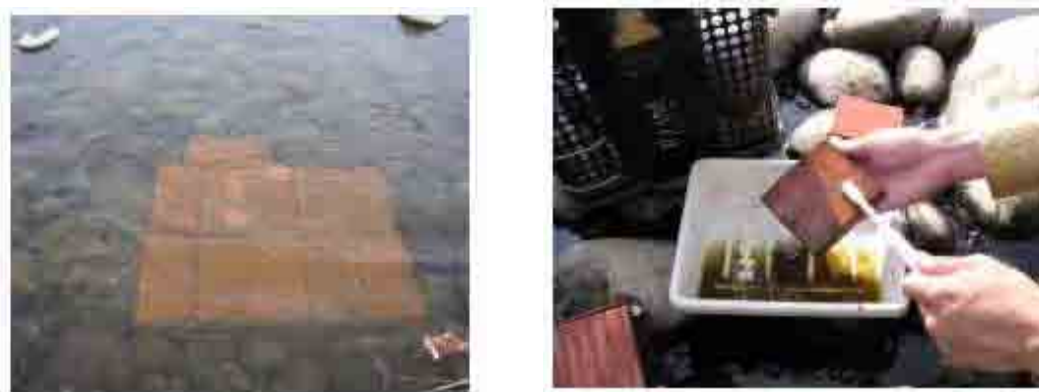
図 8 調査方法(左：付着板の設置 右：試料採取)
