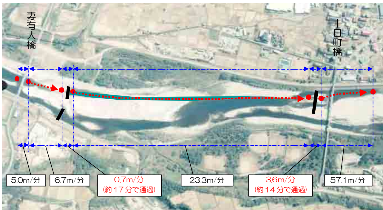
図 7.2-8 遊泳速度低下地点(床固)
