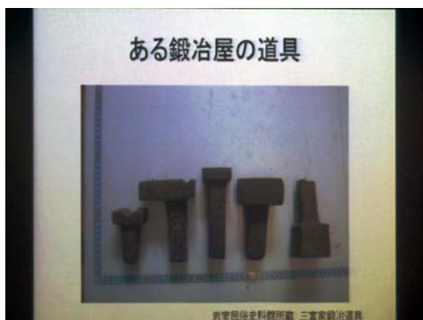
大河津分水工事で実際に修理等に使われたと考えられている「当てビシ」。金属を加工する際に槌(ツチ)とともに使用しました。
