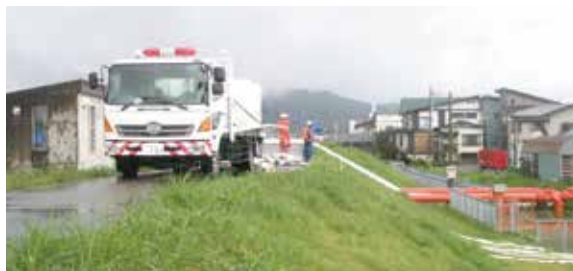
排水ポンプ車による排水状況
