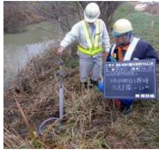
(試験施工における地中変位計の測定状況)
