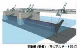
可動堰（新堰）（ラジアルゲート形式）
