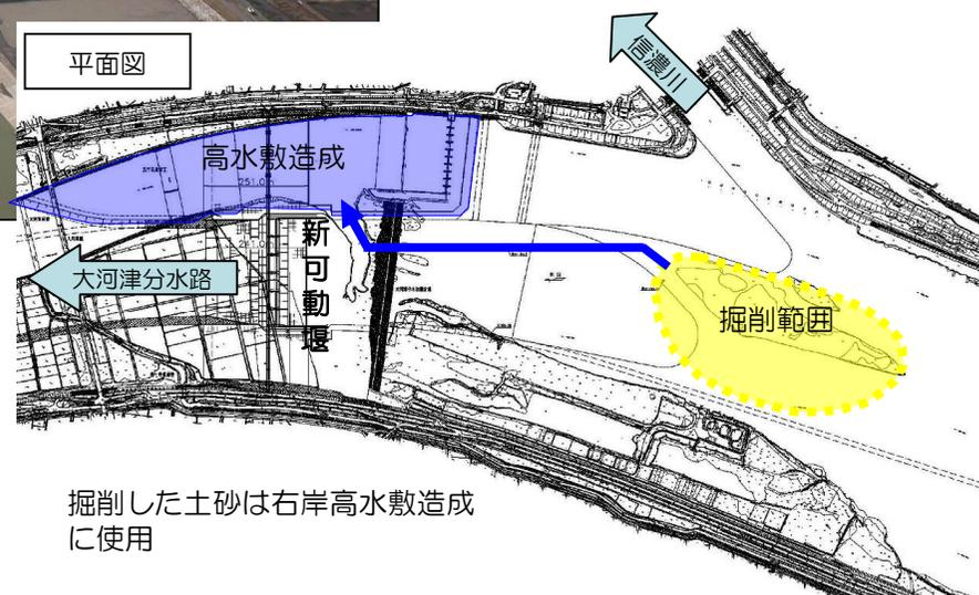
掘削した土砂は右岸高水敷造成に使用
