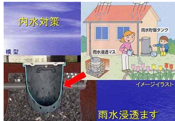
図 - 36 内水対策・雨水浸透ます
