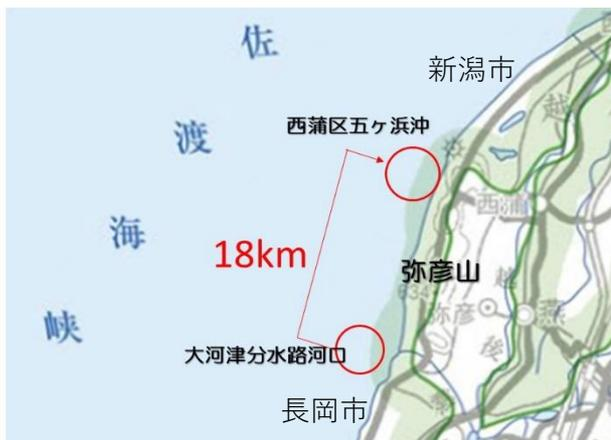
航路浚渫土砂 海上運搬先位置図（図5-2）
