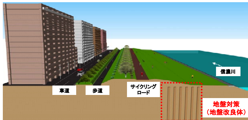
写真 54 耐震対策の完成イメージ
