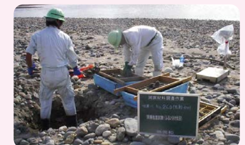
▲河川の調査実施状況（河床材料調査）
