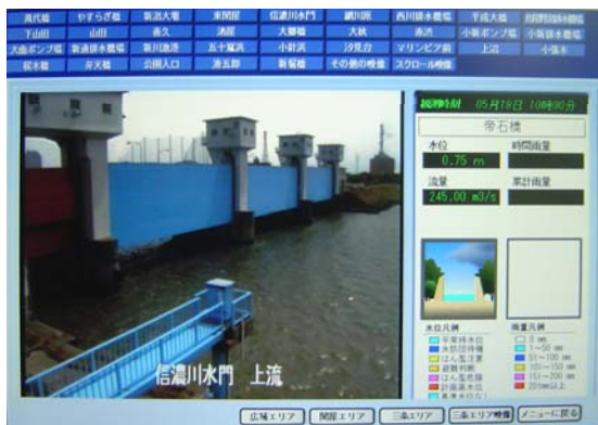
管内CCTV映像、水位情報の提供
