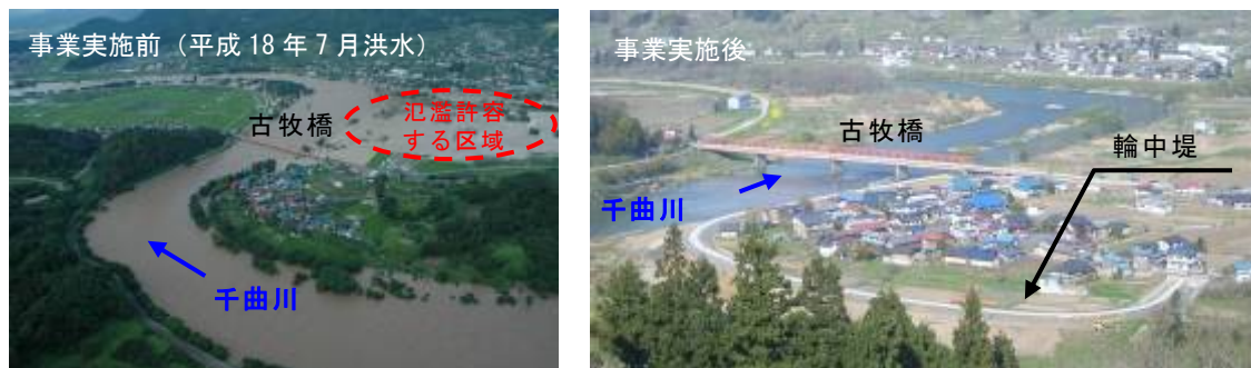
写真 4 土地利用一体型水防災事業で輪中堤を整備した中野市古牧地区(千曲川)
