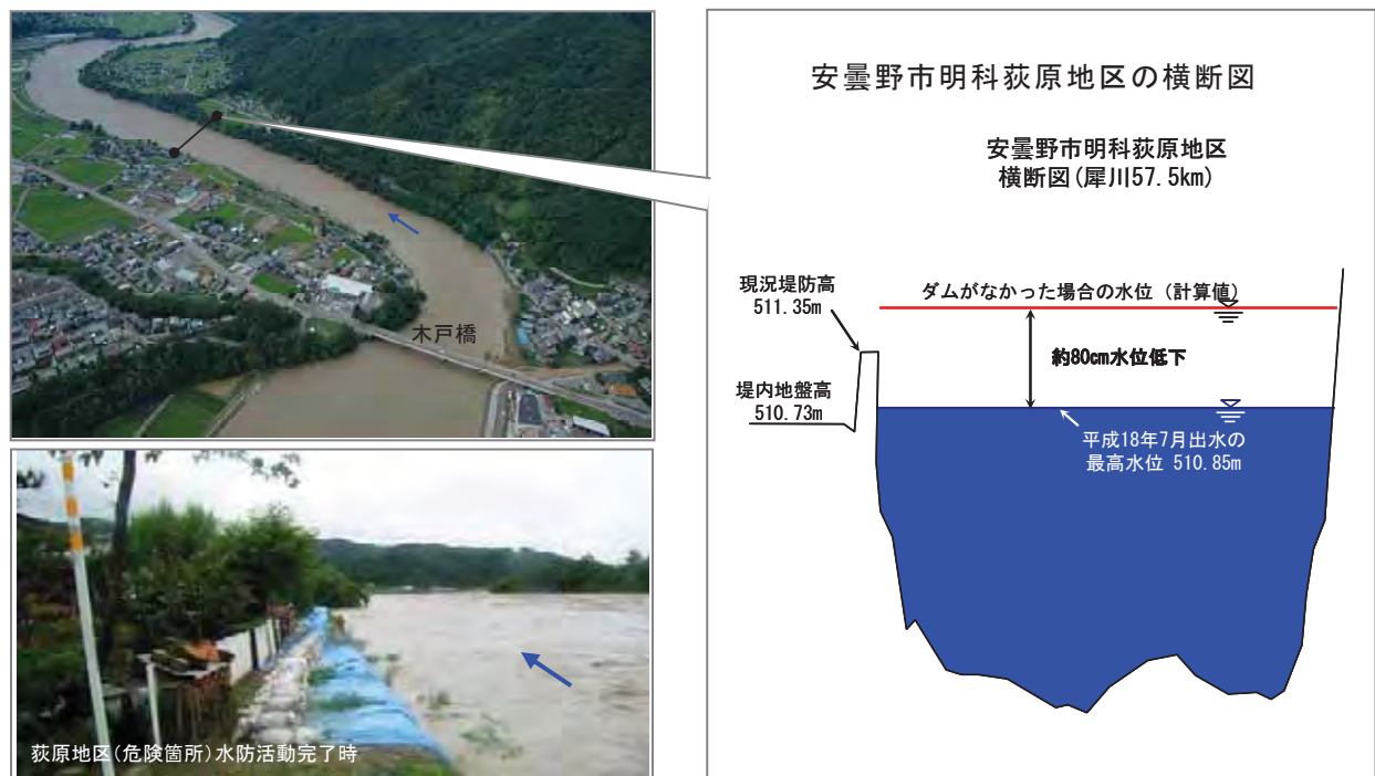
図15 平成18年7月洪水時の利水ダム群連携操作による効果の概要
