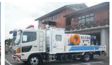
赤浜防災ステーション 災害対策機械（排水ポンプ車）
