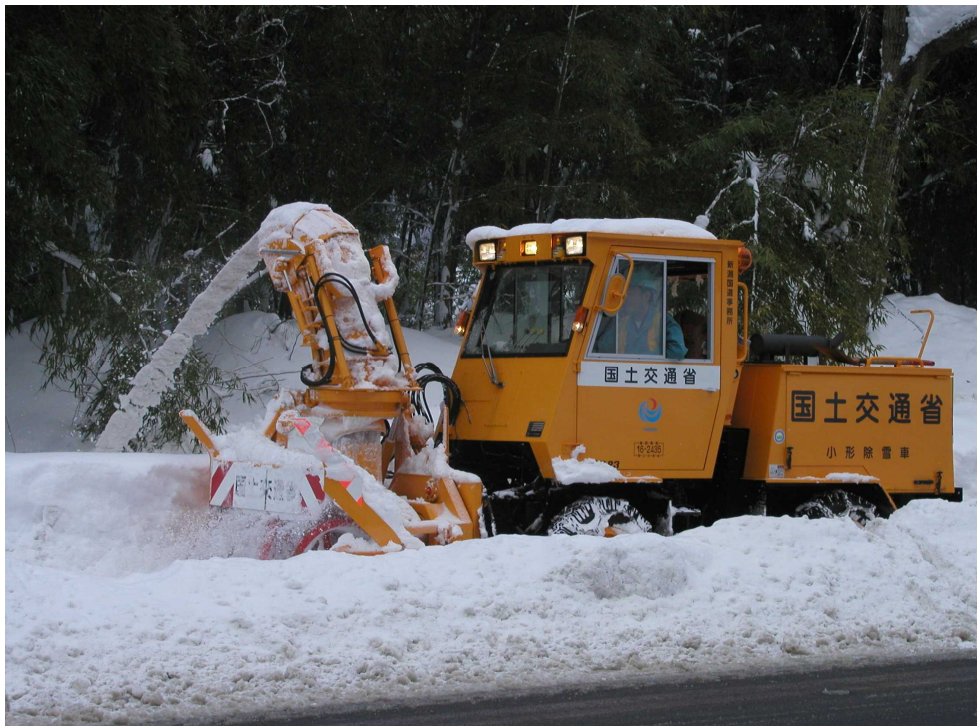
派遣する機械と同型のロータリー除雪機
