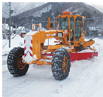
路面整正作業
