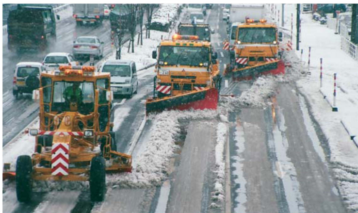
除雪グレーダと除雪トラックによる梯団作業
