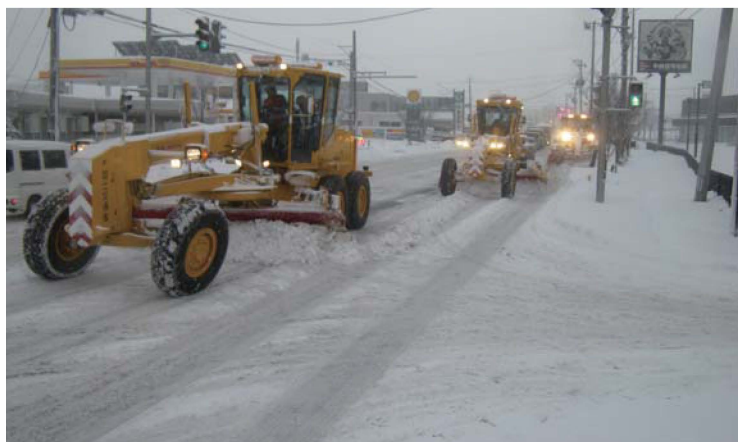
除雪グレーダによる梯団作業
