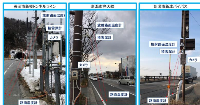
図16 路面温度計の設置
