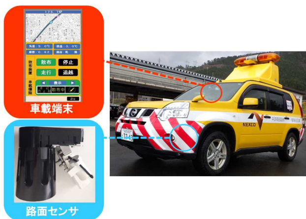
図 3. 道路巡回車の路面センサ構成
