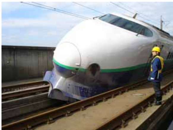
脱線した上越新幹線 (H16.11.1撮影)
