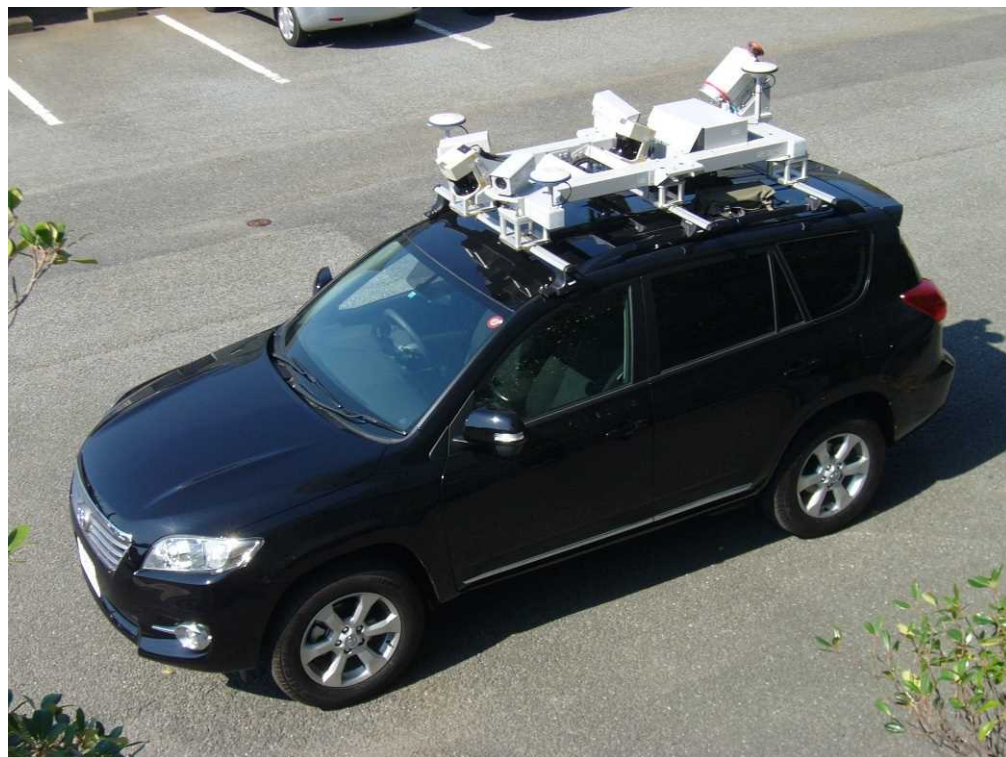
計測車両 : モービルマッピングシステム (MMS)
