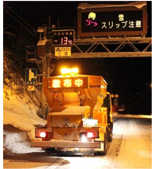
凍結防止剤散布【国道17号 新潟県南魚沼郡湯沢町】 (H24.12.25撮影)
