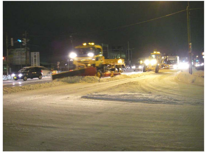
梯団による除雪【国道8号 石川県金沢市】 (H24.1.26撮影)
