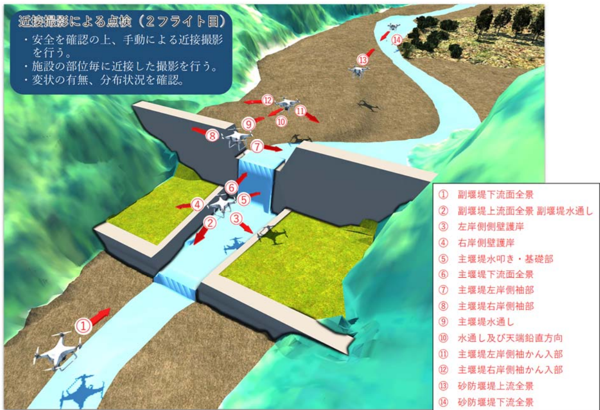
図 II.3 近接撮影（2フライト目）における UAV 撮影ポイント設定の例
