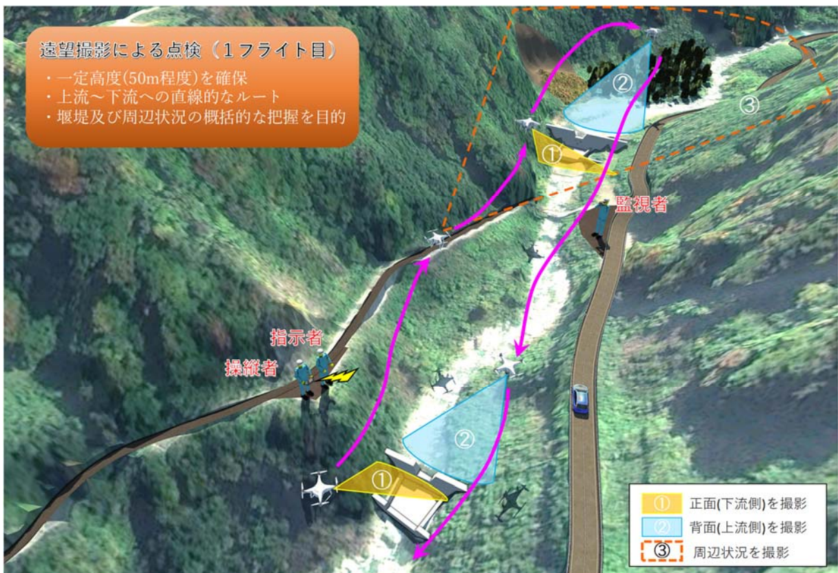
図 II.2 遠景撮影（1フライト目）における UAV 撮影ポイント設定の例
