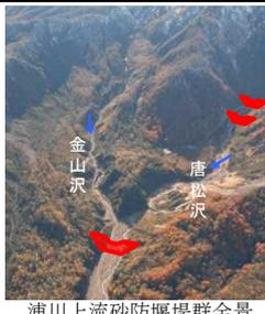
姫川支川の浦川流域には、明治44年8月の稗田山大崩壊による大量の崩壊土砂が現在も不安定な状態で堆積しています。併せて上流の唐松沢においても荒廃が著しく土砂流出が顕著なため、土砂災害発生の危険性が非常に高い状態にあります。このため、浦川上流砂防堰堤群は、荒廃の著しい浦川上流域に砂防堰堤群を整備します。
