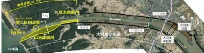
大河津分水路の河口部は、洪水を安全に流下させるための断面が不足しており、戦後最大規模の洪水が発生した場合、計画高水位を超過し堤防決壊のおそれがあることから、分水路を拡幅し、洪水を安全に流します。
