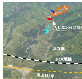
飯豊山系(荒川流域)上流の杉立沢では、地すべり性の崩壊に伴い河道閉塞が生じています。今後の出水により土砂流出が発生した場合、直下流にある国道113号やJR米坂線をはじめとした荒川流域への被害が懸念されるため、砂防堰堤の整備を推進します。
