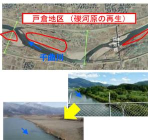
千曲川では、砂利採取等による河床低下によって低水路と高水敷の高低差が拡大し、礫河原および湿性植物群落が増える反面、アレチウリ、ハリエンジュ等の外来種が侵入・拡大し、もともと千曲川に生息する在来種の生息環境が減少・悪化しています。本事業は河道掘削を進めることで礫河原および湿性植物群落の再生を図ります。
