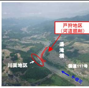
千曲川では、昭和57年、58年に連続して発生した洪水や、近年の平成16年10月、平成18年7月洪水の際に家屋への浸水被害が発生しました。洪水による浸水被害を防止するため、戸狩地区狭窄区間の河道掘削を実施することで、洪水時の水位低下を図ります。
