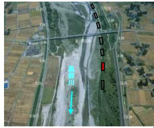
黒部川は、日本でも有数の急流河川であり、洪水時の流れが速く、土砂を含んだ洪水流が流下し、氾濫を繰り返してきました。下立(おりたて)地区は、水衝部であるうえ、堤防が決壊した場合、黒部市の中心市街地及び工場地帯等に甚大な被害が予想されます。そのため、堤防の侵食対策を計画的に実施します。
