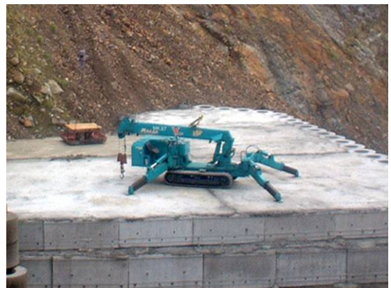
写真1.2 無線ミニクローラクレーン(2.9t吊締固用)
