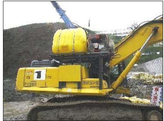
写真1.15 バックホウボディへの装備
