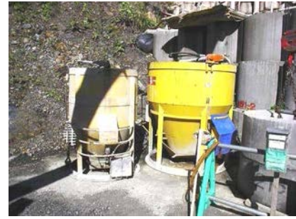
写真1.8 無線コンクリートバケット (左 0.8\text{m}^3 右 1.5\text{m}^3 )
