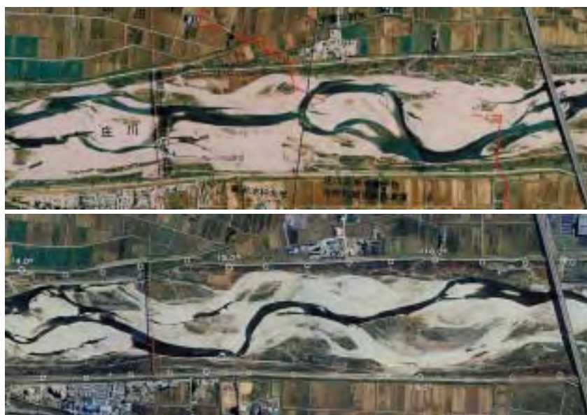
図 2.4 砂州及びみお筋の変化(庄川 14.0~16.6k 付近)
