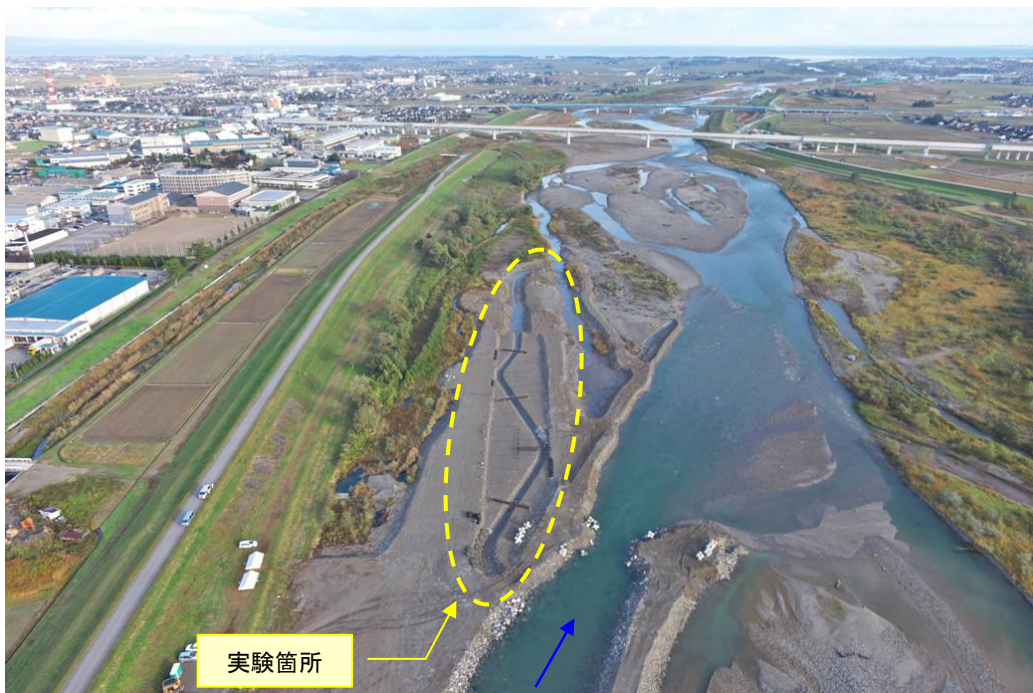
図 3.1.13 常願寺川の実際の滞筋に見立てた実験水路 (2011年 (平成23年) 実験)
