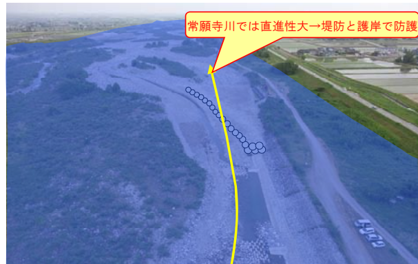
図 3.1.1 急流河川の河岸防護の考え方
