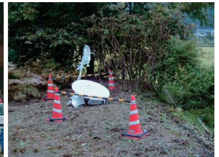
Ku-SAT現地設置状況
