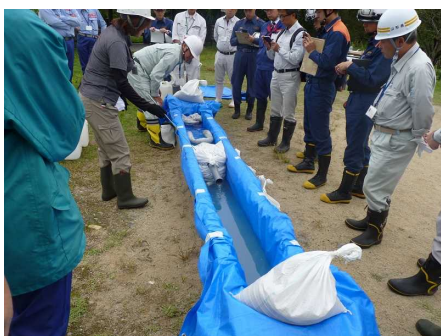
側溝での油回収実験
