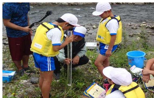
透視度計を使って濁り具合を調査
