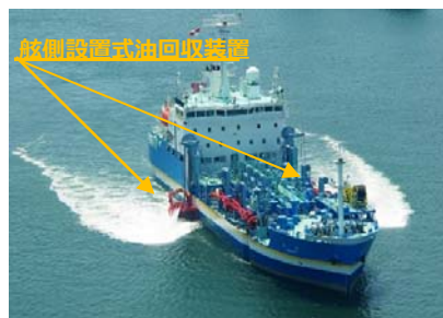
取り込んだ油と水はサイクロン室で遠心分離され、給水ポンプで油分だけが船内の回収油水槽へ送られます。
