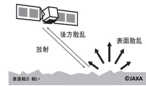
衛星SAR（合成開口レーダ）画像を活用し、汀線の位置を継続的に把握し、海岸線をモニタリングする技術
