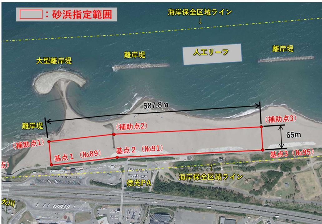
海岸保全施設として管理すべき、防護機能を有する砂浜の範囲（イメージ）：下図の赤枠の範囲
