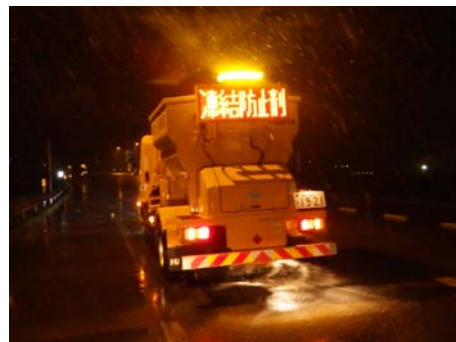
薬剤散布車 国道470号 水見IC付近における散布状況
