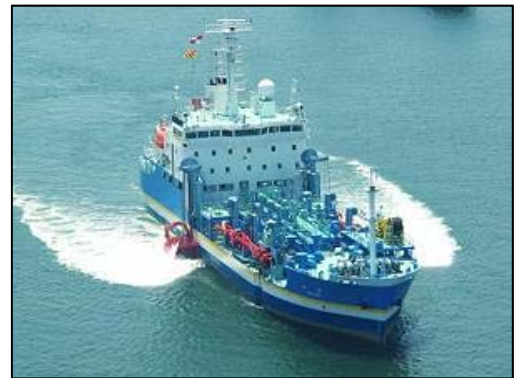
大型浚渫兼油回収船「白山」
