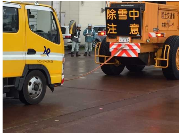
車両移動訓練の様子(H28.11.17) 除雪車の牽引による車両移動
